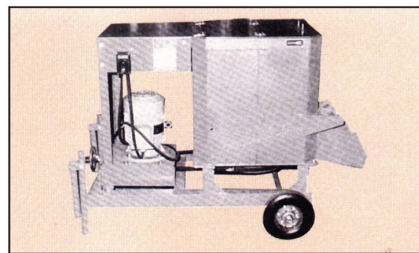
照片-2. 長方形高速攪拌機
